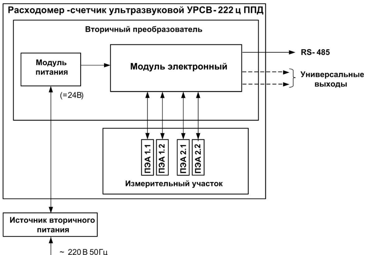
Рис. 2. Структурная схема расходомера.
