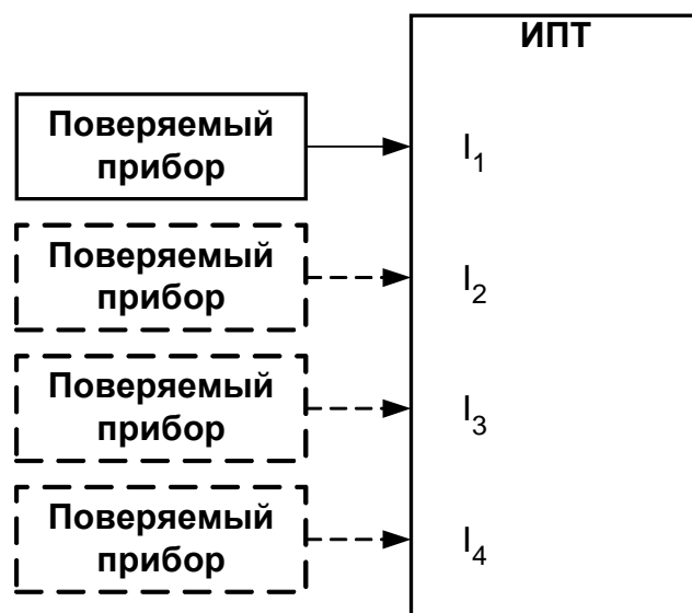
Рис. 13. Схема сопряжения поверяемых приборов с ИПТ.
