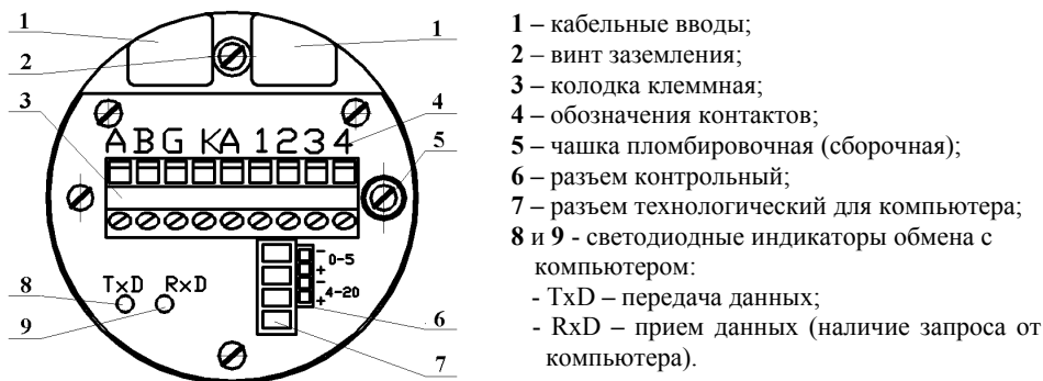
Рисунок Б.3 Панель задняя датчика моделей 5XXX
