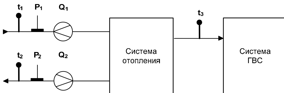
Рис. 3. Схема теплоснабжения «Пользовательская» с расчетом по разности масс
