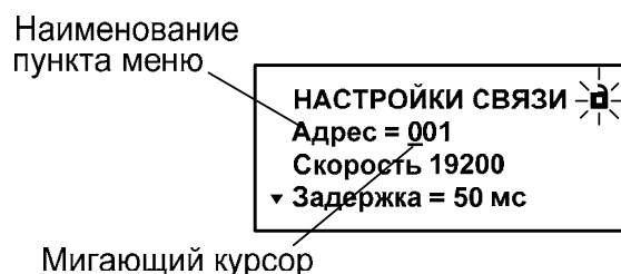
Рис. 2. Пример установки сетевого адреса прибора
