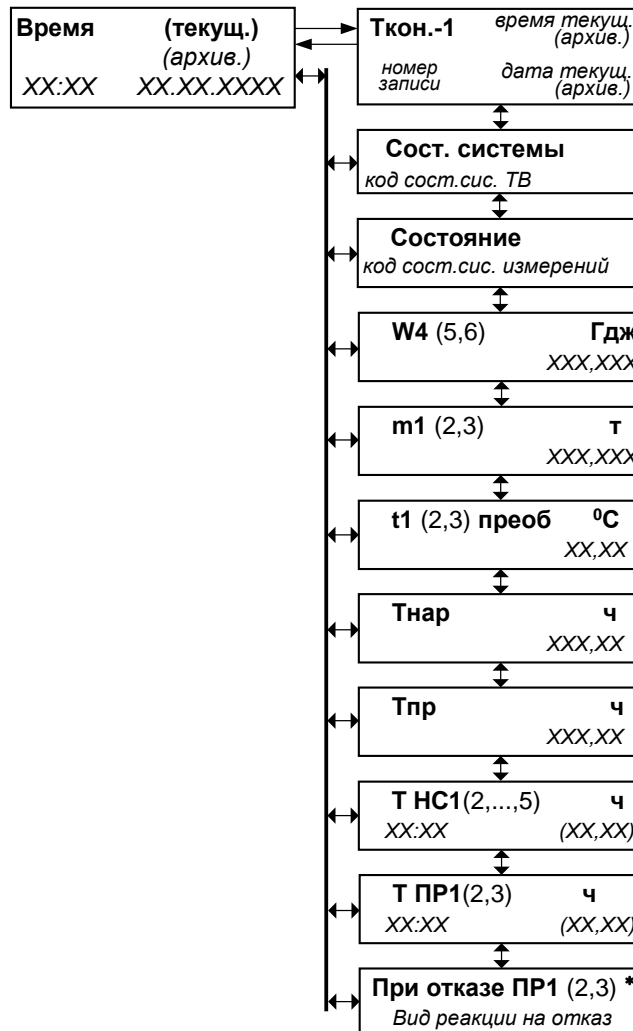
Рис. 3. Структура окон индикации буферного накопителя (архивной записи).
