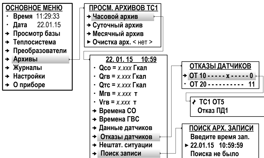
Рис.43. Вид окон индикации меню «Архивы» (режим СЕРВИС).
