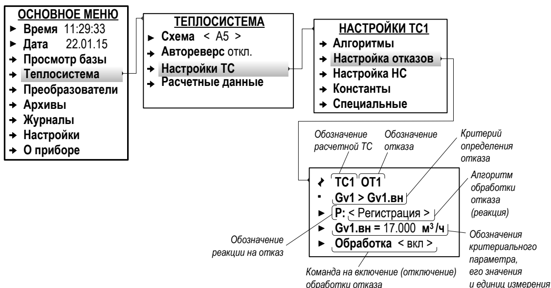
Рис.36. Вид меню настройки обработки отказов (режим СЕРВИС).
