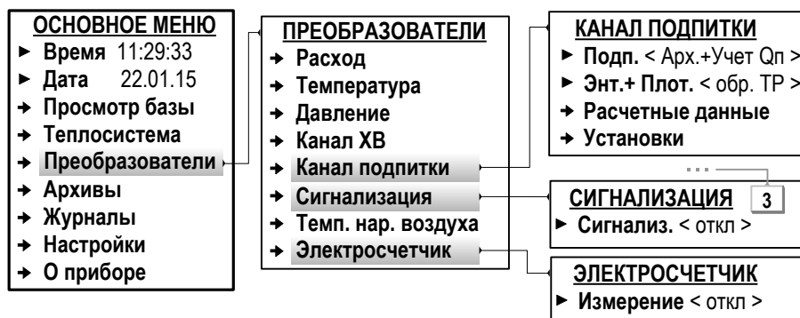
Рис.34. Вид меню «Канал подпитки» (режим СЕРВИС).
