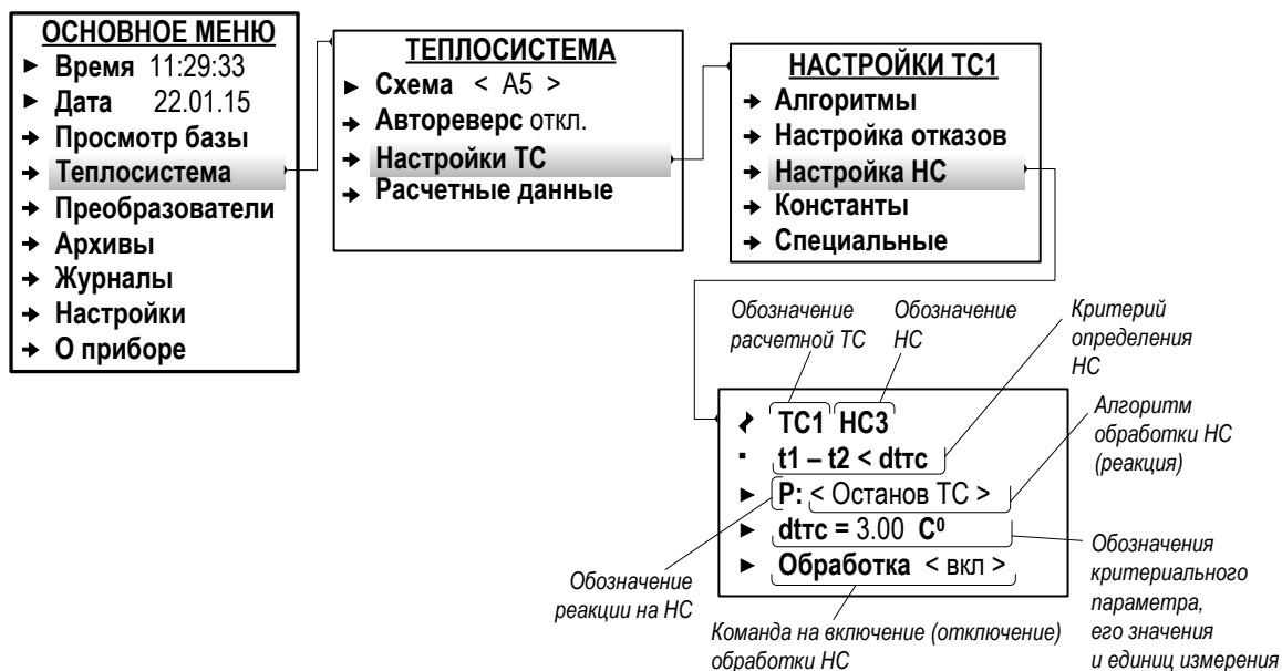
Рис.37. Вид меню настройки обработки НС (режим СЕРВИС).
