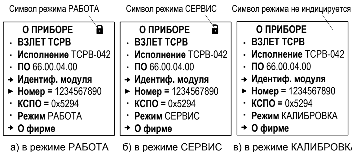
Рис.6. Вид окон индикации «О ПРИБОРЕ» в различных режимах управления.
