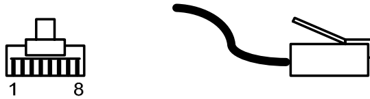
а) вид и нумерация контактов разъема RJ45
